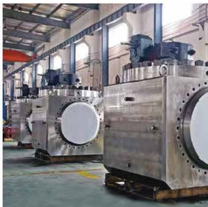
Top entry ball valve for Singapore LNG plant.
